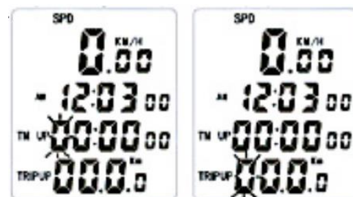
Настройка на TM UP и TRIP UP
